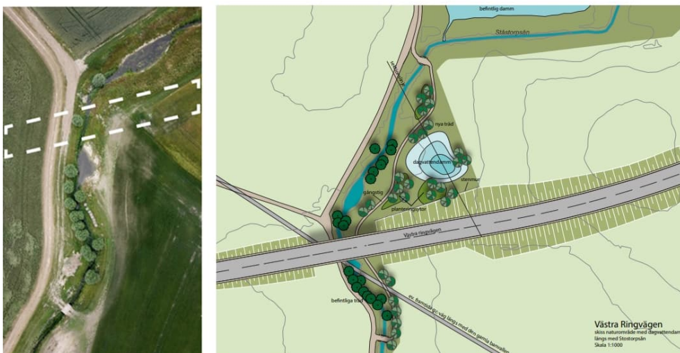
Figur 16. Flygbild över Ståstorpsån. Streckat område visar var vägen korsar ån. Figur till höger visar föreslagen utformning av väg, bro samt naturområde vis Ståstorpsån. Bildkälla: Trelleborgs kommun.
