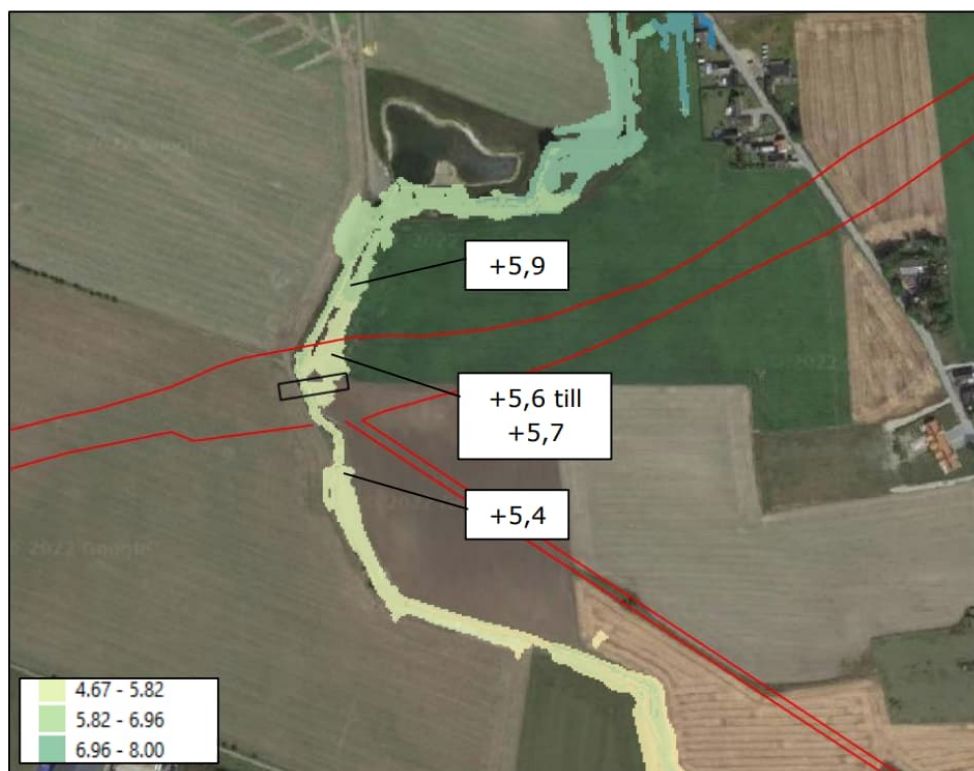
Figur 44. Översvämningsutbredning från Ståstorpsån vid scenario A som baseras på DHI:s modellresultat. Svart linje representerar projekterad utbredning av bro och en röd linje motsvarar vägområde. Höjder på vattennivå vis Ståstorpsån redovisas också (Dagvatten och skyfallsutredning Västra ringvägen, Ramböll 2023-01-20).
